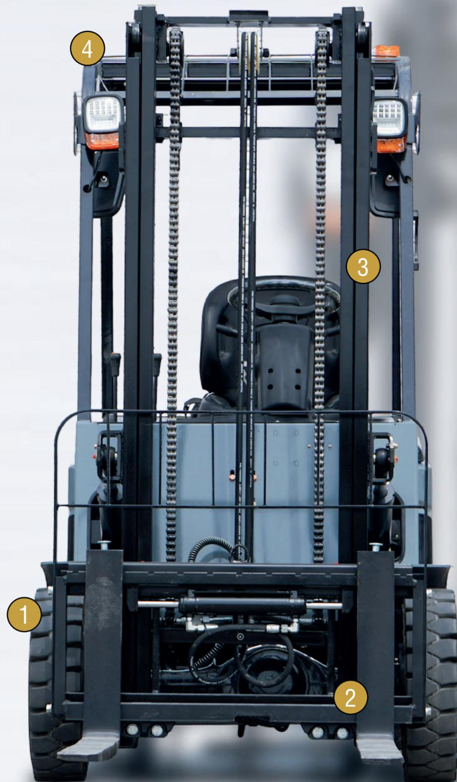
Las **Ruedas Sólidas** garantizan una **Tracción Óptima** en Cualquier Superficie de Trabajo, desde terrenos irregulares hasta Superficies Lisas o Resbaladizas. Gracias a su diseño robusto y sin aire, ofrecen una mayor resistencia al desgaste y eliminan el riesgo de pinchazos.
